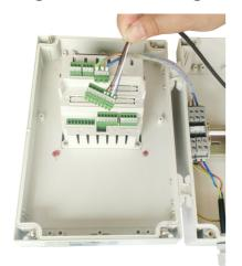
1. Öffnen Sie das S305-Gehäuse und entfernen Sie zuerst das Sensorkabel, das am Display-Terminal angeschlossen ist. Siehe das linke Bild. Ziehen Sie dazu den gesamten Stecker ab.
