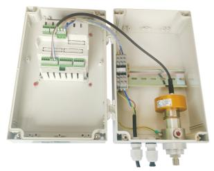
2. Schließen Sie das Stromversorgungskabel wie im Abschnitt 7.4 Elektrischer Anschluss beschrieben an.
