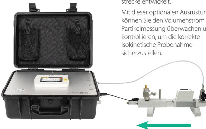
S600 Tragbarer Druckluftreinheitsanalysator
